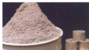
アルミ切り粉の圧縮固形
