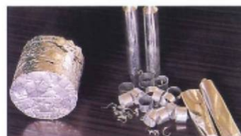
アルミプレス屑の圧縮固形
