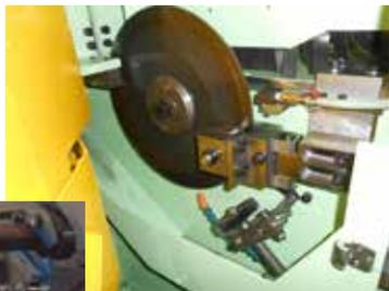
フレ止め、冷却で高速切断
