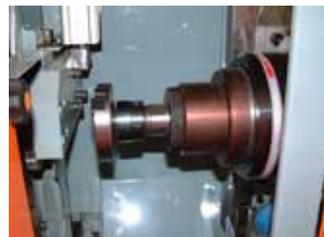
面取りの芯出しは素材径の入力で完了します。
