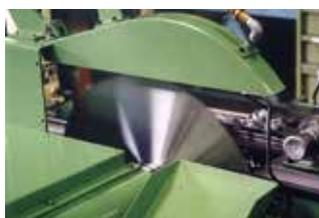
湯口切断専用超硬チップソー
